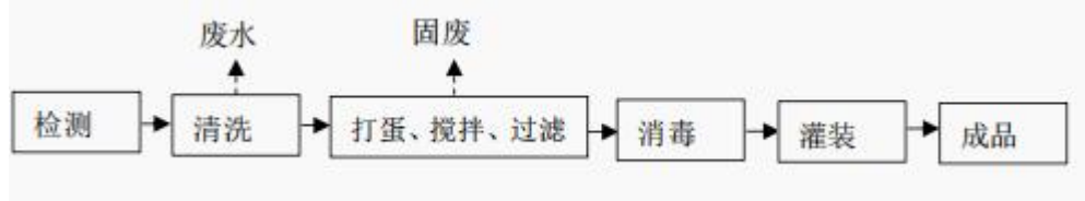
图 2-4 蛋液生产工艺流程及产污环节图
